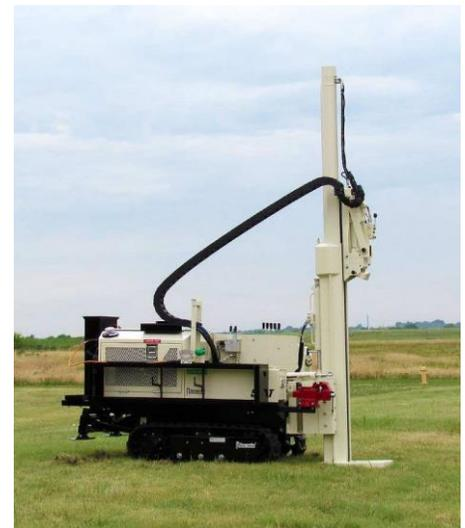
Máquina de perforación del suelo
