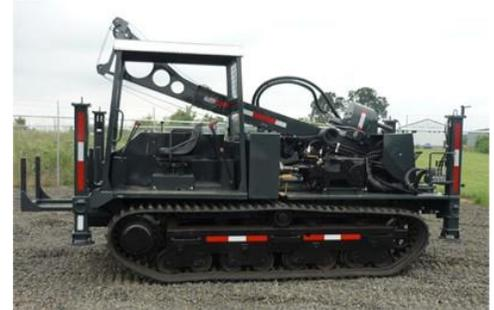
Máquina de perforación del suelo
